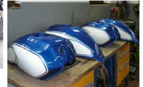
Die Serienmotorräder werden gestrippt, die Tanks lackiert, Schriftzüge und Felgenzierringe per Hand angebracht.
