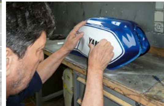
Die Serienmotorräder werden gestrippt, die Tanks lackiert, Schriftzüge und Felgenzierringe per Hand angebracht.
