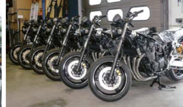
Die Serienmotorräder werden gestrippt, die Tanks lackiert, Schriftzüge und Felgenzierringe per Hand angebracht.
